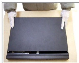
2. ábra Tető leemelése
