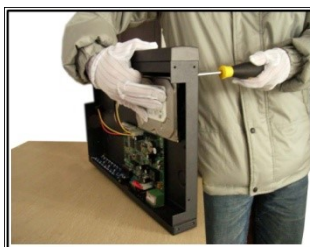
3. ábra HDD becsavarozása
